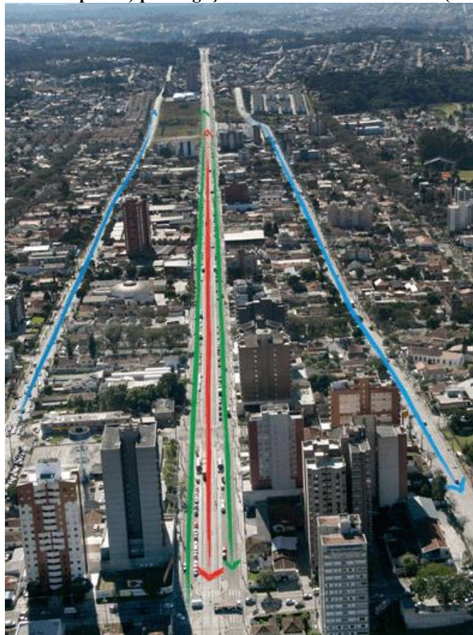
Figura 26: Sistema trinário de vias: via central para ônibus expressos e tráfego local e vias laterais (de sentidos únicos e opostos) para ligação dos bairros com o centro (e vice-versa).
