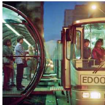
Figuras 21 e 22: O pagamento desembarcado da tarifa é feito nas estações tubo (e também nos terminais de integração); acesso aos ônibus com embarque em nível a partir de múltiplas portas de embarque.
